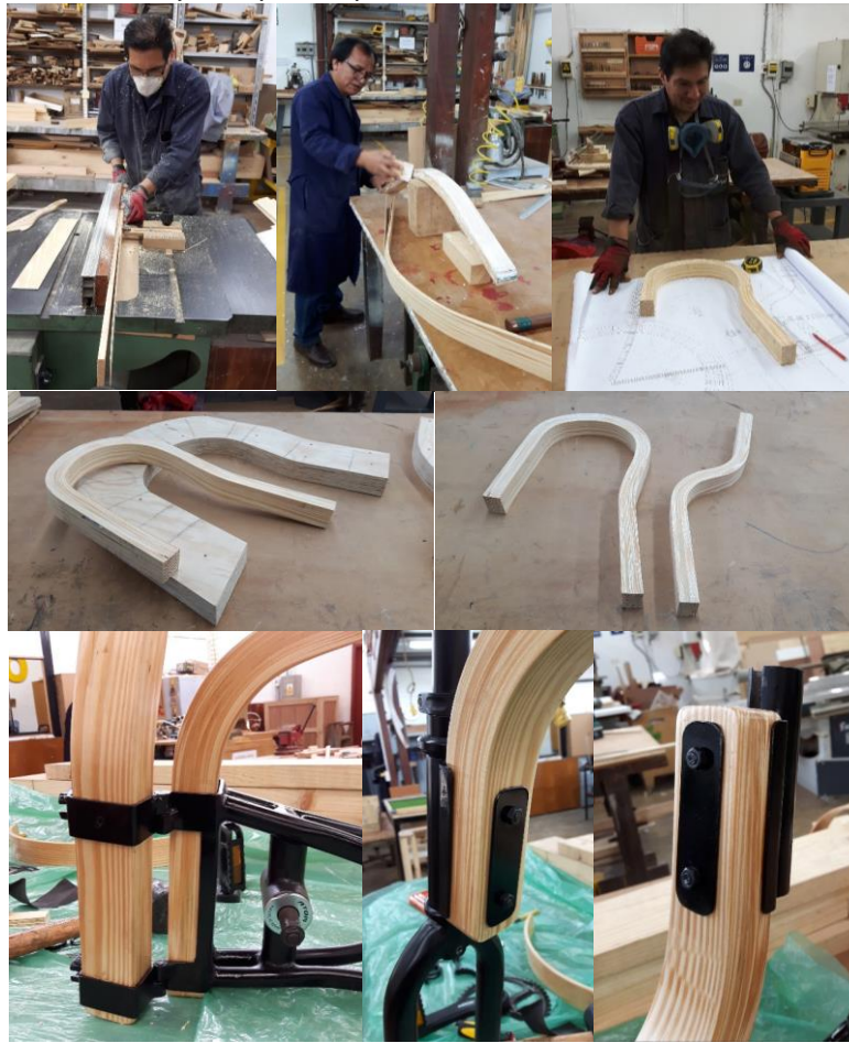
Figura 5. Algunas imágenes del proceso y los sistemas de plegado y unión
