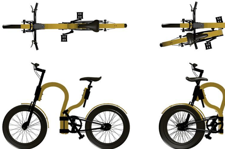
Figura 2. Vistas de la bicicleta en posición de uso y plegada.
